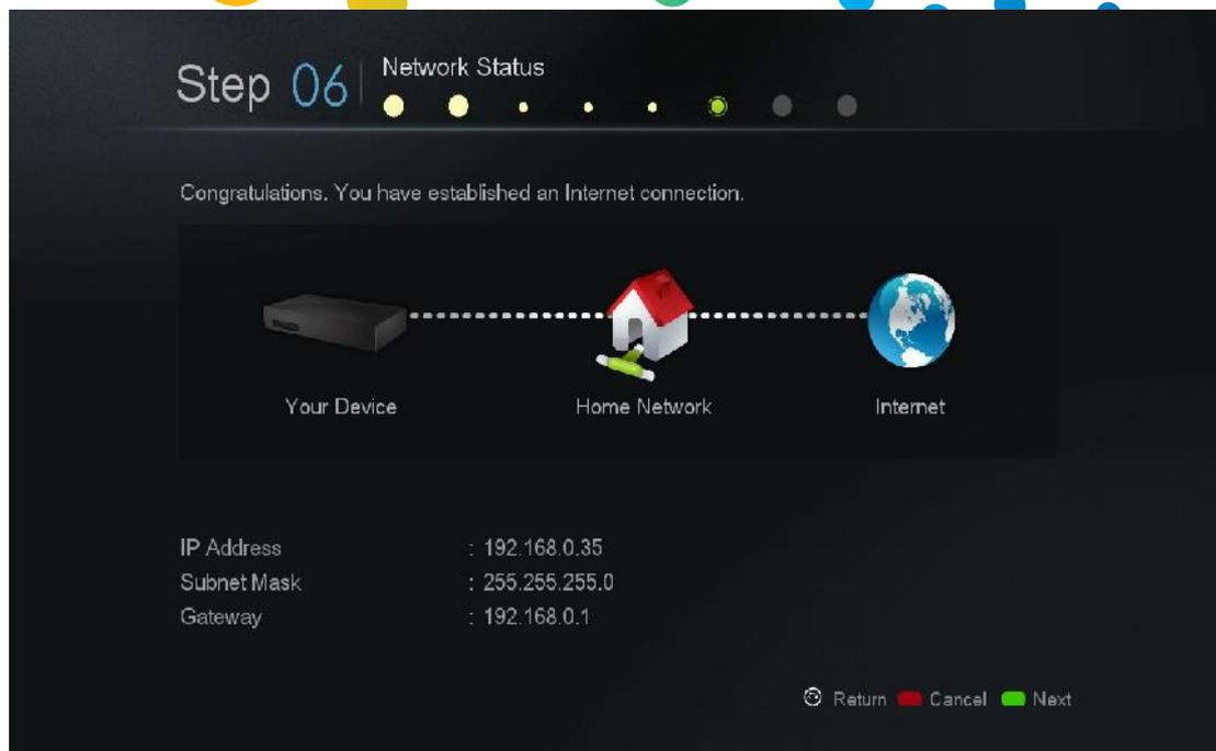
Verifica della connessione di rete e della connessione internet. Se appare il messaggio di “Congratulazioni”, la procedura di configurazione è terminata con successo.
