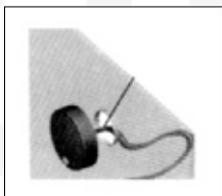
Inserite i cavi nel coperchio posteriore e chiudete l'unità riavvitando le viti.
