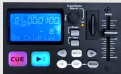
Particolare del display con scheda SD inserita ed indicatore a led acceso.
