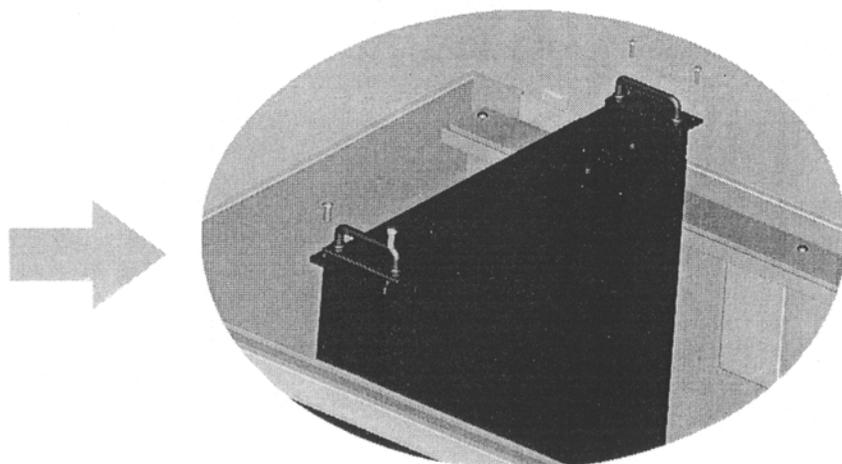
4) Usando le viti in dotazione potrete installare le apparecchiature frontali.
