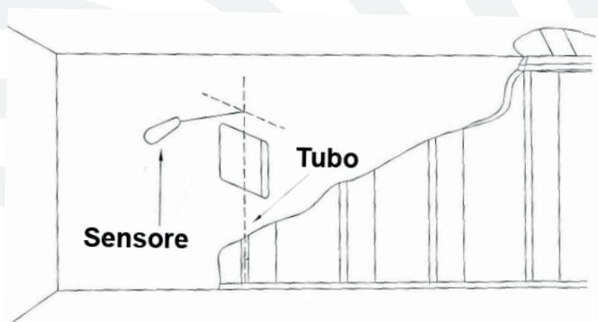
2) Effettuati i quattro fori, inserite i tasselli in dotazione, appoggiate correttamente la staffetta a parete e fissatela con le quattro viti per tasselli in dotazione. Fate attenzione che la posizione della staffa rispecchi quella in figura sottostante.
