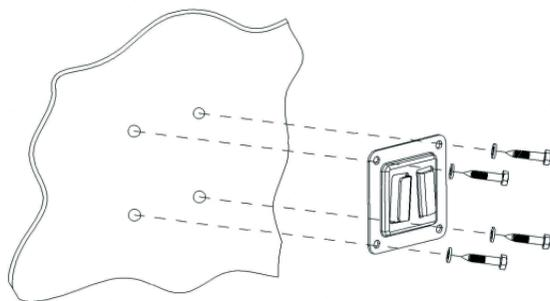
3) Appoggiate delicatamente il vostro schermo LCD su una superficie piana magari posizionando prima un telo che prevenga righe o danneggiamenti allo schermo. Applicate la seconda staffa allo schermo facendo combaciare i fori della piastra con quelli sul retro dello schermo. La staffa è compatibile con i seguenti standard:
