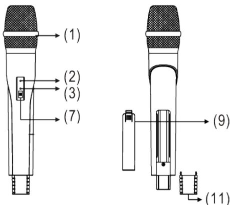
1. Inserite le batterie nei radiomicrofoni, aprendo il vano batterie(9) e avendo cura di rispettare le polarità indicate.
