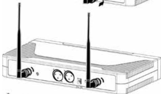
Avvitare le due antenne girandole nel senso indicato
