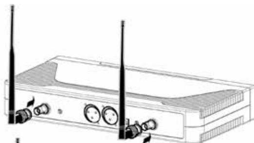
Inserite le due antenne alle prese BNC poste sul pannello posteriore della base ricevente
