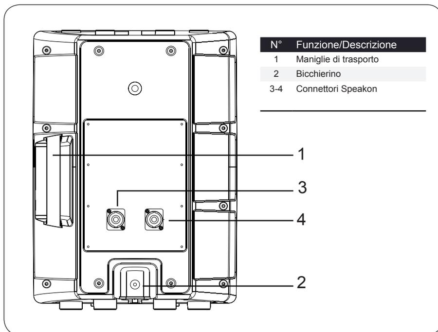
1. Posizionate in un luogo idoneo il vostro nuovo diffusore avendo cura che tale luogo non sia umido o esposto ai raggi diretti del sole. Sugeriamo, dove possibile, il posizionamento su treppiede (esempio: mod. Karma TL 152K) tramite bicchierino(2), che permetterà al diffusore di diffondere il suono più in profondità senza essere schermato da persone o oggetti vicini.
