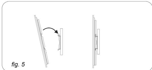
L'ultima fase dell'operazione consiste nell'agganciare le due staffe poste sul retro dello schermo TV alla staffa fissata a muro (fig.5).
