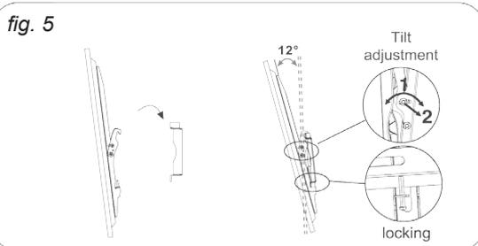
L'ultima fase della operazione consiste nell'agganciare le due staffe poste sul retro dello schermo TV alla staffa fissata a muro e, dopo aver regolato l'eventuale inclinazione, bloccare lo schermo tramite la vite inferiore (fig. 5).
