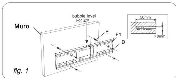
Per prima cosa posizionate la staffa principale a parete assicurandovi, tramite la bolla di livello, che sia perfettamente orizzontale. Marcate i fori con una matita, praticate i fori con trapano e fissate la staffa a parete.
