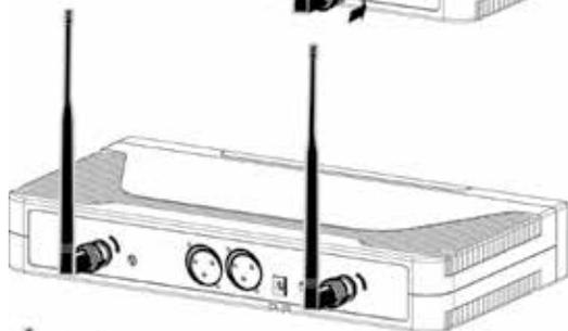
Avvitate le due antenne girandole nel senso indicato
