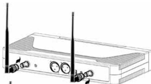
Inserite le due antenne alle prese BNC poste sul pannello posteriore della base ricevente
