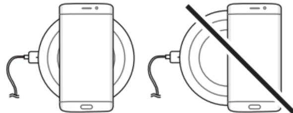
3) Posizionate correttamente il telefono al centro del caricatore(a). Errata posizione causa il non caricamento o interruzioni dello stesso. I led(c) segnalano, illuminandosi, che il telefono è in fase di carica. I led si spengono a ricarica ultimata. In caso di falsi contatti ed interruzioni nella carica, verificate il corretto posizionamento del telefono.
