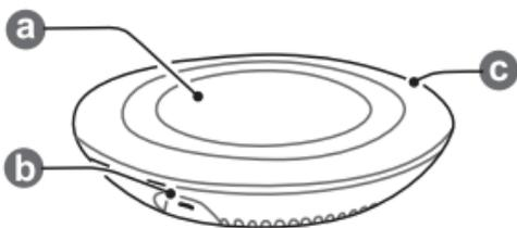
1) Collegate il cavo USB in dotazione alla presa(b) quindi inseritelo in una comune presa USB in grado di fornire almeno 2A.
