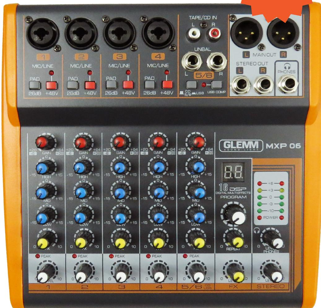
Mixer microfonico professionale a 6 canali con prese di uscita bilanciate, processore DSP e presa USB per la connessione a computer sia in entrata che in uscita. Dispone di alimentazione phantom inseribile indipendentemente sui 4 canali microfonici, tasto PAD per l'attenuazione immediata di 26dB. L'alimentatore è esterno per la riduzione di possibili interferenze.
