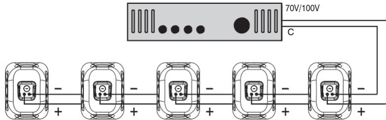
**5 SPEAKERS CONNECTED IN PARALLEL USING 16W TAPS**
