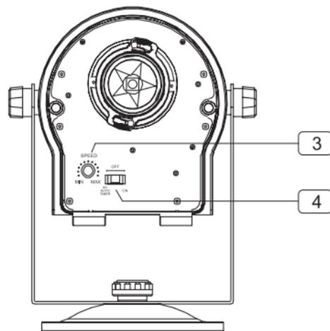
Il selettore(4) permette di accendere il proiettore, spegnerlo o avviare il timer di 6 ore dopo le quali si spegnerà per 18 ore coprendo il ciclo giornaliero. Il comando(3) regola la velocità di rotazione del gobo. Estraiete o inserite il corpo frontale(1) per regolare la messa a fuoco.
