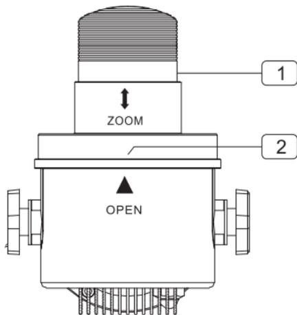
Se volete impiegare il proiettore al chiuso, applicate la bassetta che consente di appoggiarlo, se volete utilizzarlo in giardino, applicate il picchetto e conficcatelo nel prato. Inserite la spina in una presa di corrente e aprite il coperchio magnetico(2).
